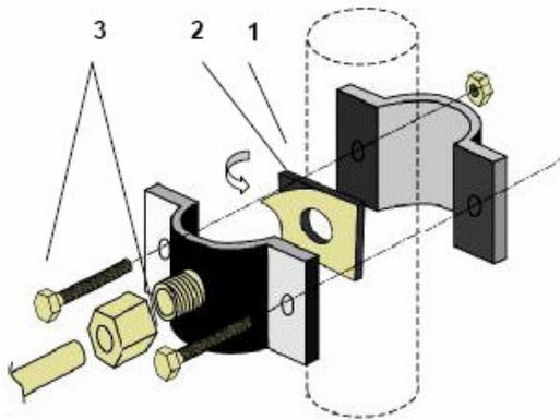
Die Siphonschelle ist eine Vorrichtung zum Anschluss des Abwassers (Spülwassers) eines spülbaren Filters an den Abfluss.
