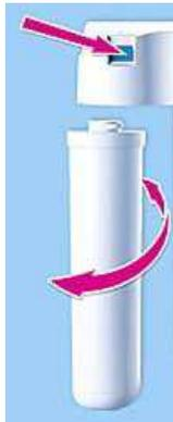
Gesamte Filtereinheit nach oben aus der Hülse herausziehen, blauen Entriegelungsknopf drücken und Filter nach links drehend ausklicken.
