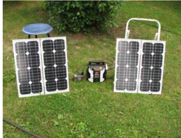
Der Akku zum Betrieb einer elektrischen Pumpe wird über ein Solarmodul aufgeladen. Bei entsprechender Ausführung ist auch der Betrieb einer Osmosefiltration möglich.
