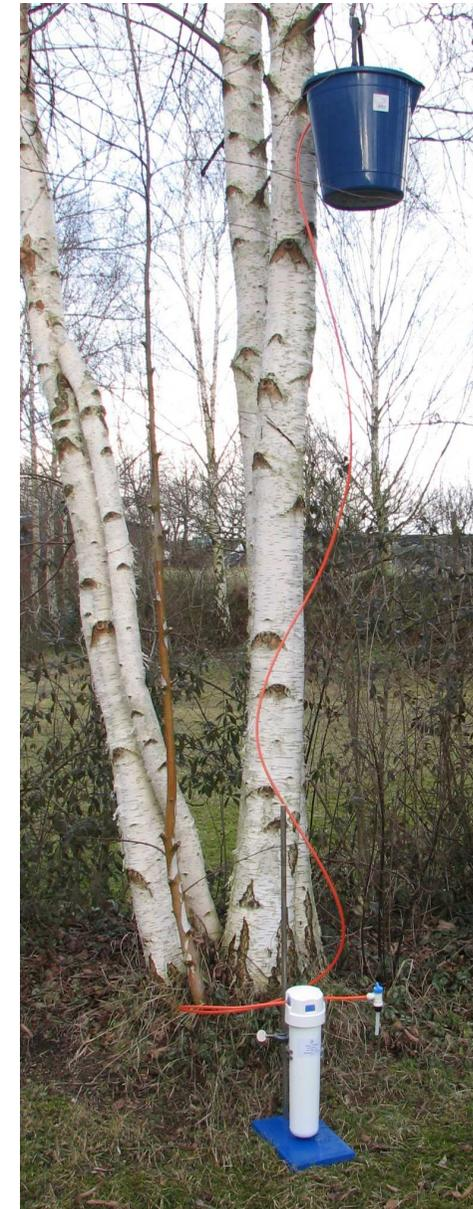
Ein Höhenunterschied von 2 Metern genügt bereits für eine langsame Filtration.
