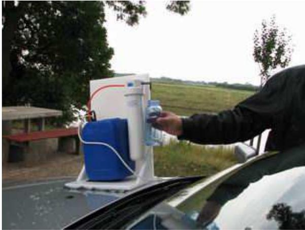
Abb.: Vorratskanister, QuickChangefilter mit Aktivkohleblock und Mikrofiltration  $0,1\ \mu\text{m}$ , 12 Volt DC Adapter mit Tauchpumpe (im Kanister), siehe Bild unten, Typ BWV 04 Dauerbetrieb 6 bis 9 Volt DC, 30 Minuten Intervallbetrieb 12 bis 14 Volt DC], Filterleistung: ca. 2 Liter/Minute bei 12 Volt und 0,5 bar.
