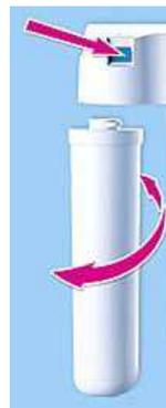
Beim Filterwechsel wird nur der Verriegelungsknopf gedrückt und der Wechselfilter mit einer ¼ Umdrehung aus- und eingesetzt.
