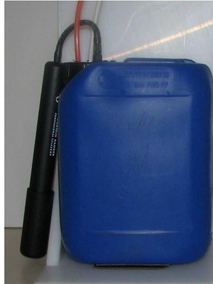
Die externe Luftpumpe, Fahrradhandpumpe o.ä., baut in einem Behälter Druck auf (schwarzer Schlauch). Das zu filternde Wasser wird über den orangen Schlauch zum Filter geleitet.
