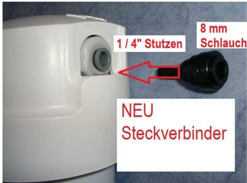
Dieser Steckverbinder ist gekennzeichnet durch einen 1/4" Stutzen und einem 8 mm Schlauchverbinder. Es handelt sich um eine Sonderanfertigung, da diese Kombination nicht im Standardprogramm der führenden Hersteller von Steckverbindern ist. Er schließt die Lücke beim Anschluss von Filtern z.B. an Tafelwasseranlagen oder im Caravanbereich etc. mit typischerweise verwendeten 8 mm Schläuchen.
