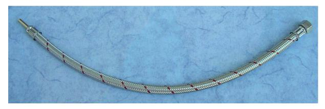
Die Ausführung besteht aus einer 3/8" Überwurfmutter (lose Dichtung) und einem ¼" Stutzen. Er ermöglicht die Verbindung zwischen den üblichen 3/8" Standardanschlüssen bzw. Eckventilen auf der einen und Steckverbinden (JohnGuest, DMT, LiquiFit etc.) in Trinkwasserfiltern auf der anderen Seite. Produkt Made in Germany.
